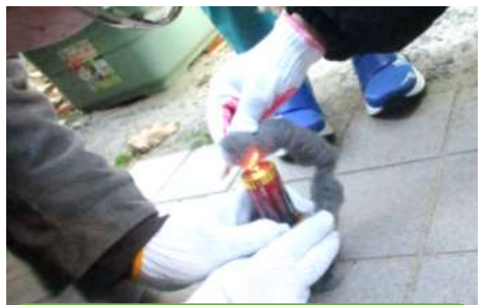
スチールウールは繊維状になるまで伸ばすことが肝心です。
