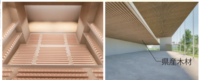
県産木材を用いた座席 県産木材の天井ルーバー
