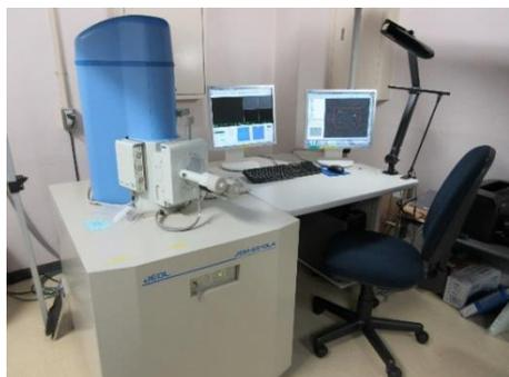
図4 走査電子顕微鏡
