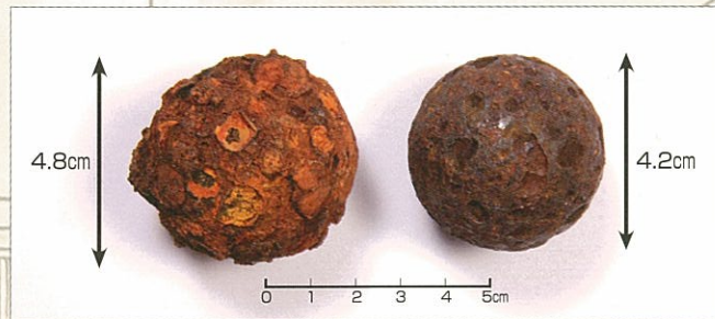
2点の炮弹 サビ落とし前(293g) 後(274g)
