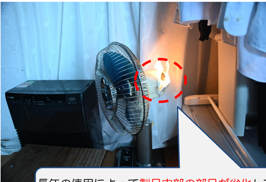
部品の経年劣化により 出火した扇風機
