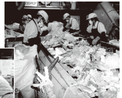
▲機械で指定袋を破いて中身をベルトコンベアに出した後、作業員が手作業で異物を取り除きます
