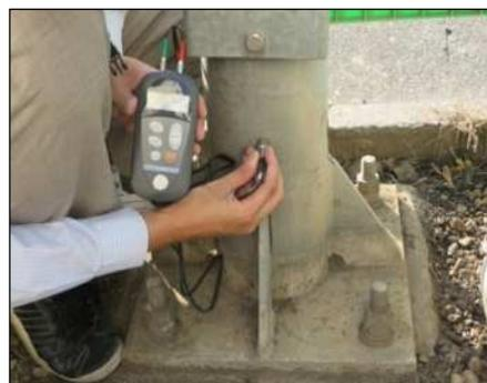
△超音波測定器を用いた板厚調査
