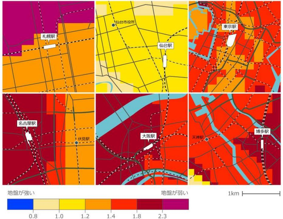
※ 上記の図は、表層地盤増幅率、いわば地震の大きさを増幅させる係数を色で示した図である。
