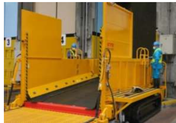
[搬入物検査装置]
