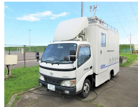
▲移動測定車による大気調査
