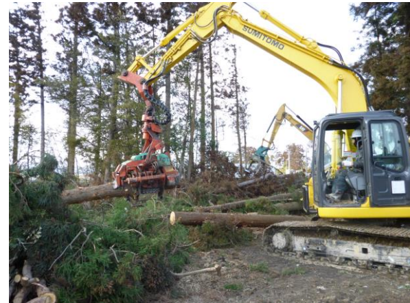
写真 8-3-4 重機による枝払い・玉切り状況
