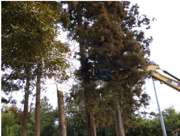
写真 8-3-3 重機（ハーベスタ）による伐採状況
