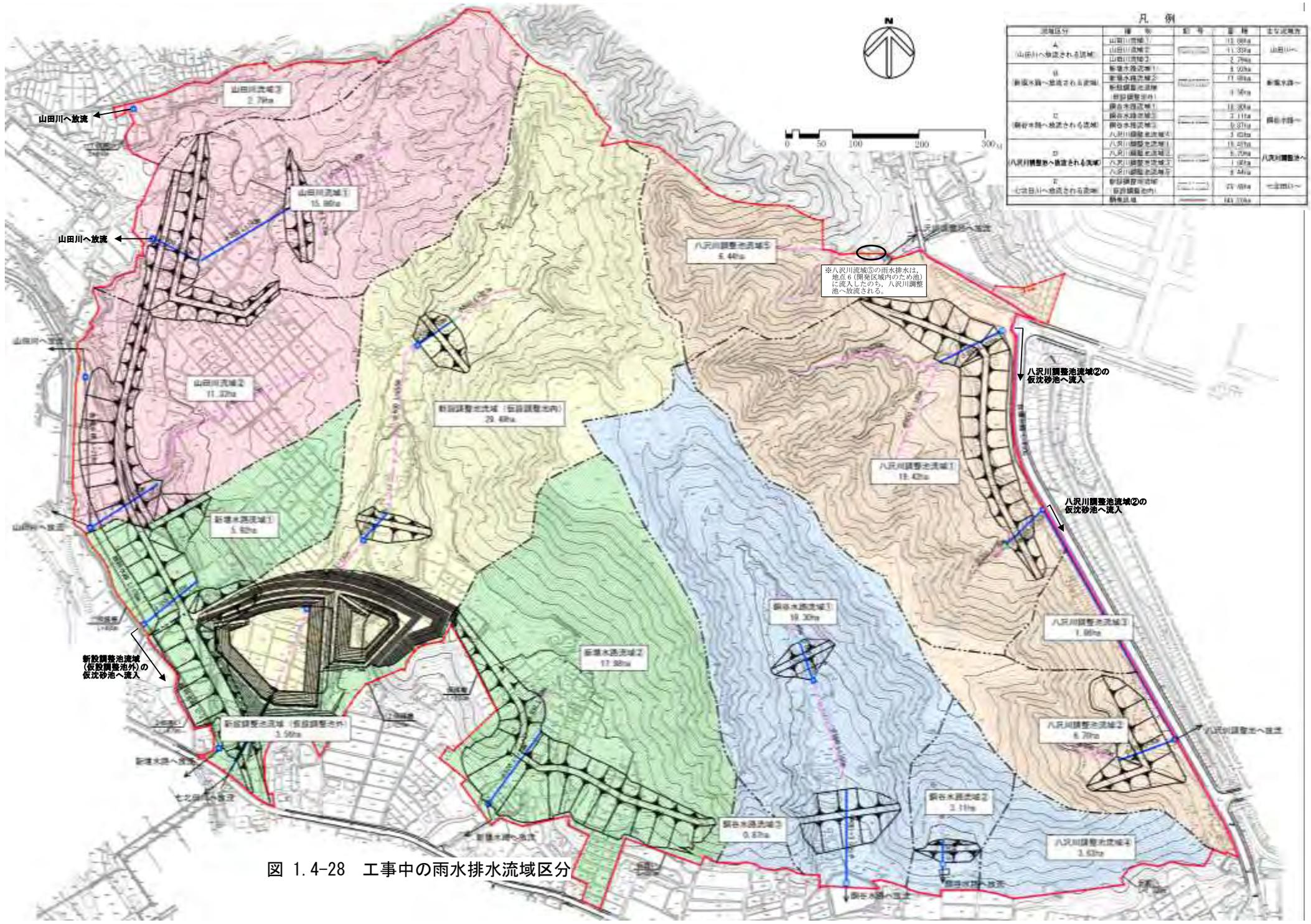
図 1.4-28 工事中の雨水排水流域区分
