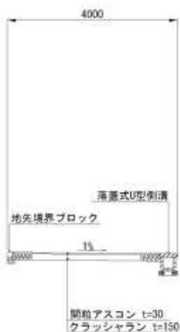
図 1.4-7(6) 道路標準断面図（自転車歩行者道）
