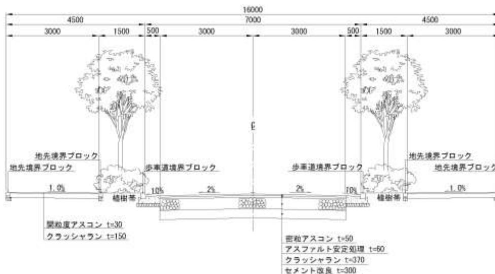
図 1.4-7(4) 道路標準断面図（住区内幹線道路）
