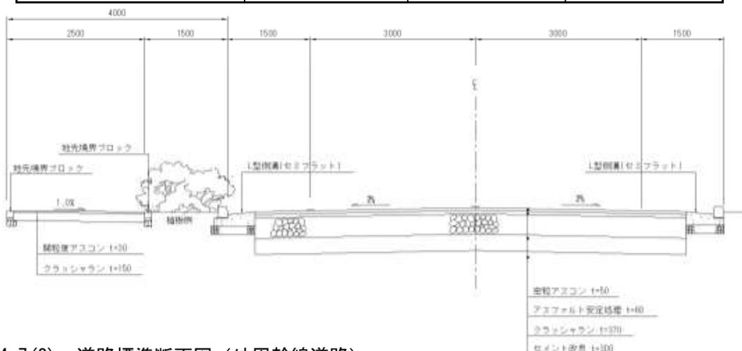
図 1.4-7(2) 道路標準断面図（外周幹線道路）
