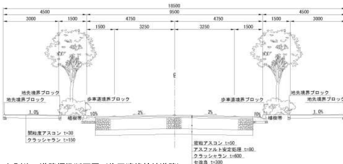
図 1.4-7(1) 道路標準断面図（住区連絡幹線道路）
