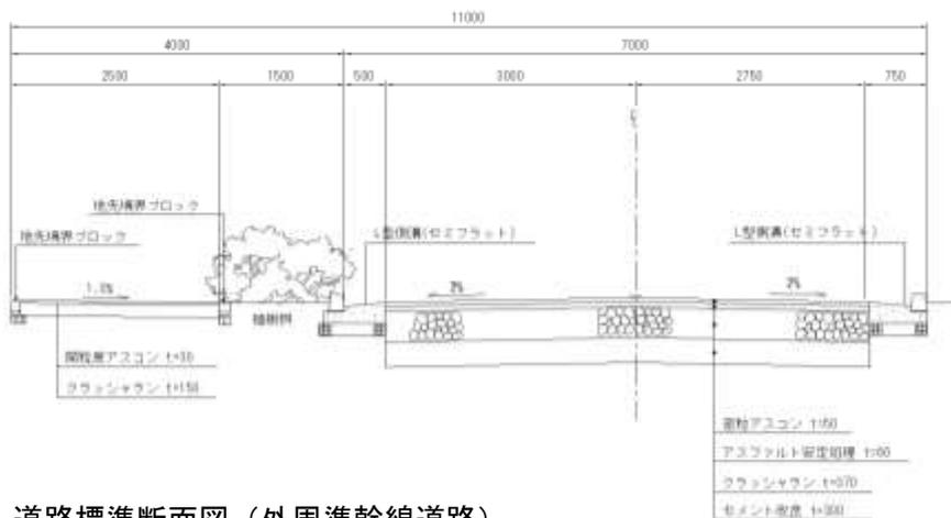
図 1.4-7(3) 道路標準断面図（外周準幹線道路）
