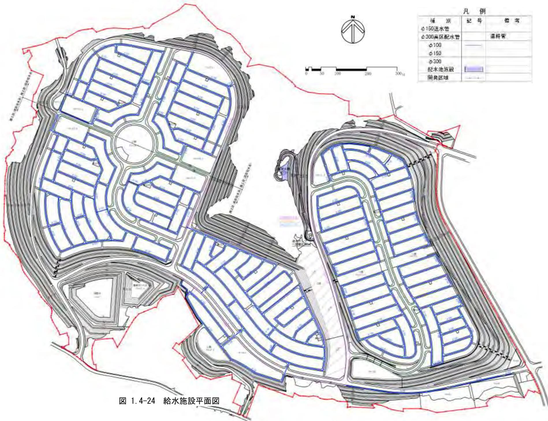
図 1.4-24 給水施設平面図
