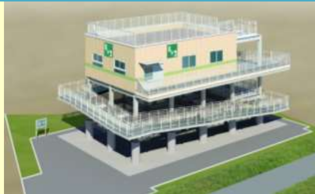
タワー型（鉄骨造）
