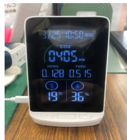
CO2センサーの設置
