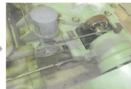
ベルト切断 修繕後
