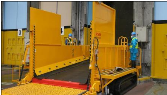
▲搬入物検査装置
