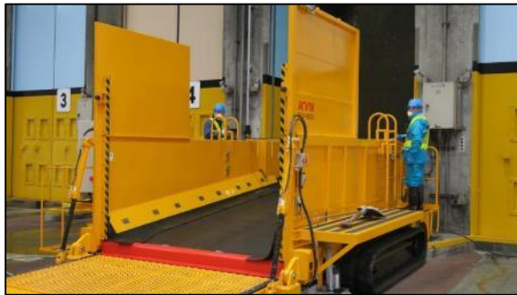
▲搬入物検査装置
