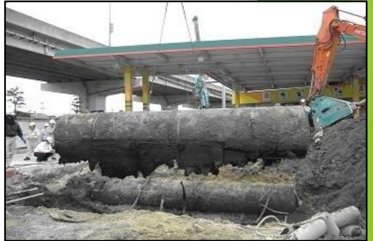
給油取扱所の地下タンクに腐食によって孔が開き、**9.2キロリットル**もの大量のレギュラーガソリンが地下に流出した事故の様子（他県の事例）
