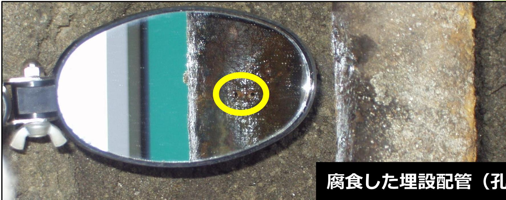
腐食した埋設配管（孔食）
