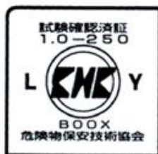
基準適合表示の例 (消防法令の基づく試験に合格した容器に表示)
