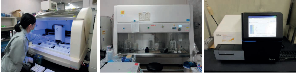
【写真左：全自動 PCR 検査機、中：安全キャビネット、右：次世代遺伝子解析装置】
