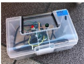
モバイルバッテリー用BLEセンサーは電源がない場所でも1日稼働することが可能
