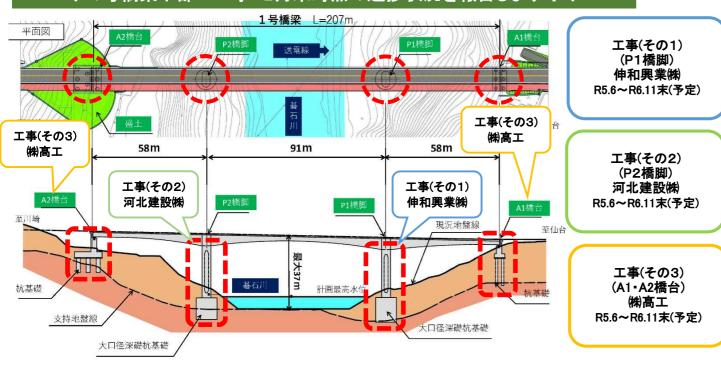
「橋脚基礎の工事は、ブレーカー及び発破による岩盤破砕により掘削しています。 | 工事期間中、騒音・振動・安全等には十分留意し施工して参りますので、ご理解・ご協力をお願い申し上げます。
