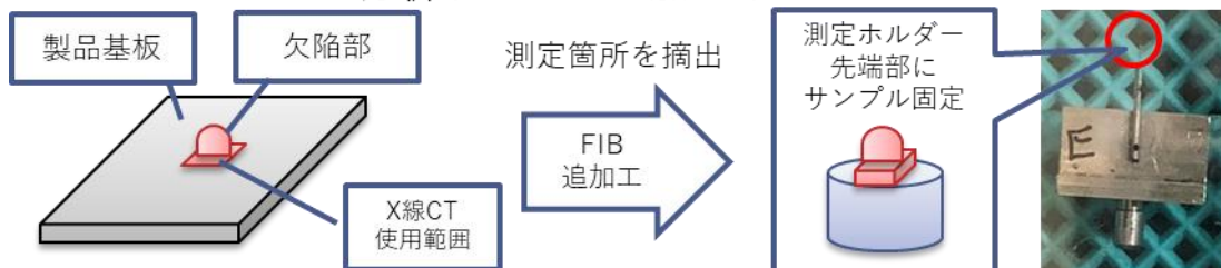
図9 放射光 X 線 CT 分析試料加工
