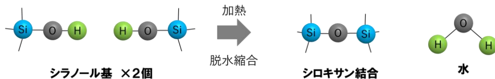
図1 バインダーの硬化反応
