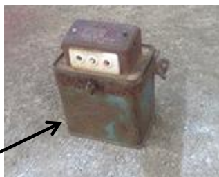
揚水ポンプの分電盤 に設置されていた 低圧コンデンサー
