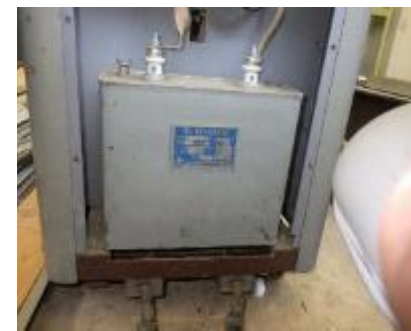
電気溶接機の側面に取り付けられた低圧コンデンサー
