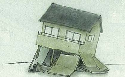
（基礎及び1階部分が崩れた住宅）
