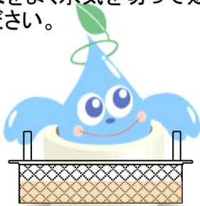
② 水面に浮いている油脂類を毎日1回、網などですくい取り、よく水気を切って処理してください。(始業前に行くと効果的です)
