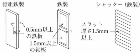
1.7 図5 防火戸（特定防火設備）の例
